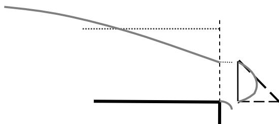
**5.2** Διώρυγα ορθογωνικής διατομής με οριζόντιο πυθμένα, πλάτους  $b$  και βάθος ροής  $y_1$ , μεταφέρει νερό με παροχή  $Q_1$ . Στη διώρυγα συμβάλλει υπό γωνία  $45^\circ$  διώρυγα ορθογωνικής διατομής με οριζόντιο πυθμένα, πλάτους  $b$  και βάθος ροής  $y_2 = y_1$ , η οποία μεταφέρει νερό με παροχή  $Q_2 = Q_1$  (βλ. σχήμα).
