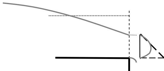
**5.2** Διώρυγα ορθογωνικής διατομής με οριζόντιο πυθμένα, πλάτους  $b$  και βάθος ροής  $y_1$ , μεταφέρει νερό με παροχή  $Q_1$ . Στη διώρυγα συμβάλλει υπό γωνία  $45^\circ$  διώρυγα ορθογωνικής διατομής με οριζόντιο πυθμένα, πλάτους  $b$  και βάθος ροής  $y_2 = y_1$ , η οποία μεταφέρει νερό με παροχή  $Q_2 = Q_1$  (βλ. σχήμα).
