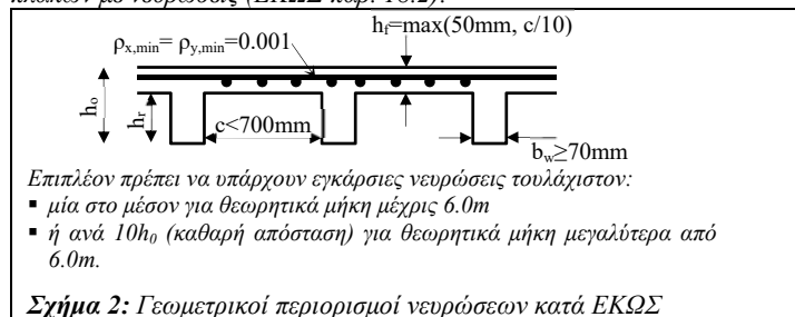
Σχήμα 2: Γεωμετρικοί περιορισμοί νευρώσεων κατά ΕΚΩΣ
